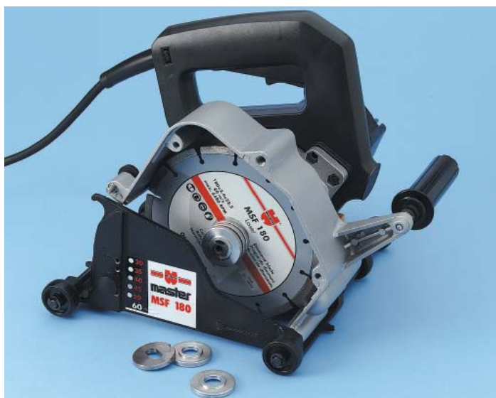
A távtartó gyűrűk segítségével állíthatjuk a vágási szélességet (1-45 mm).
